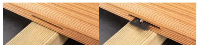
Rainurage local, à la fraiseuse à rainurer (de type Lamello®) ou à la défonceuse.
