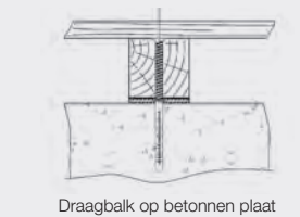
Draagbalk op betonnen plaat
