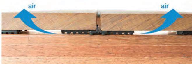
Afin de limiter le risque de confinement d'eau et d'humidité entre lames et lambourdes, il est vivement recommandé de décoller la lame de son support à l'aide des cales de ventilation NÖVLEK®.
