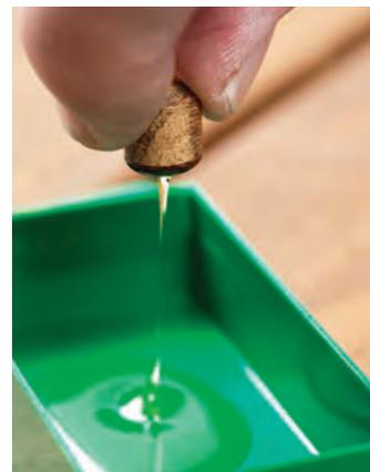
Afin d'éviter le débordement en surface de la colle PU dû à son expansion durant le séchage, il est conseillé de limiter la quantité de colle utilisée en ne l'appliquant que sur l'extrémité du bouchon.
