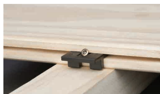
Nutung über die gesamte Länge, mit 4-Seiten-Hobelmaschine oder Nutfräser bearbeitet.
