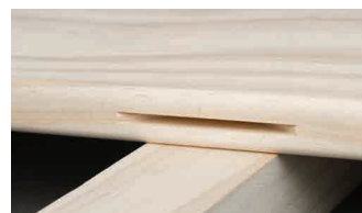
Lokale Nutung, mit Nutfräsmaschine (Typ Lamello®) oder Oberfräse bearbeitet.
