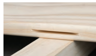
Rainurage local, à la fraiseuse à rainurer (de type Lamello®) ou à la défonceuse.
